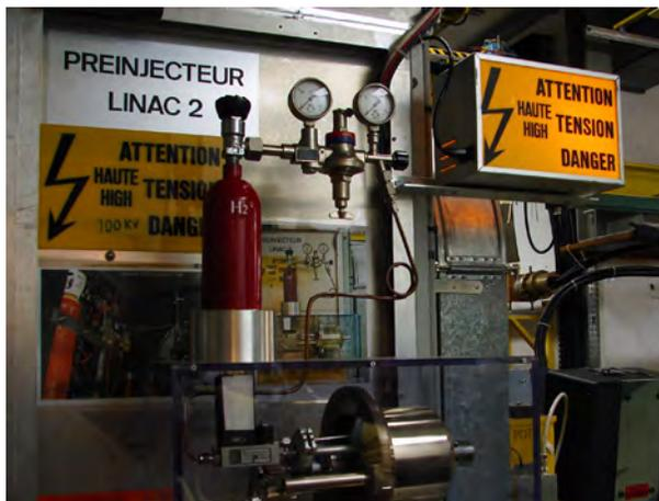
Garrafa com hidrogênio acoplada ao Duoplasmatron, fonte de prótons do LHC (acervo pessoal).
