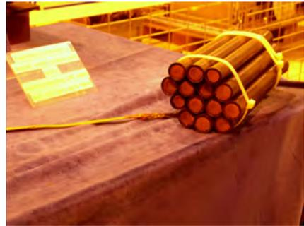
**Foto 4:** Semicondutores, junto com um feixe de cabos de cobre necessários para suportar a mesma corrente (acervo pessoal).
