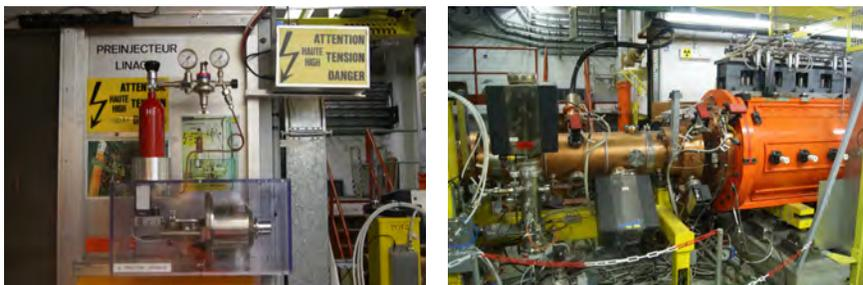
À esquerda, uma amostra de um cilindro de hidrogênio de onde provêm os prótons acelerados em todo o complexo de aceleradores. À direita, início do LINAC 2 (acervo Gabriela Kaiana Ferreira).
